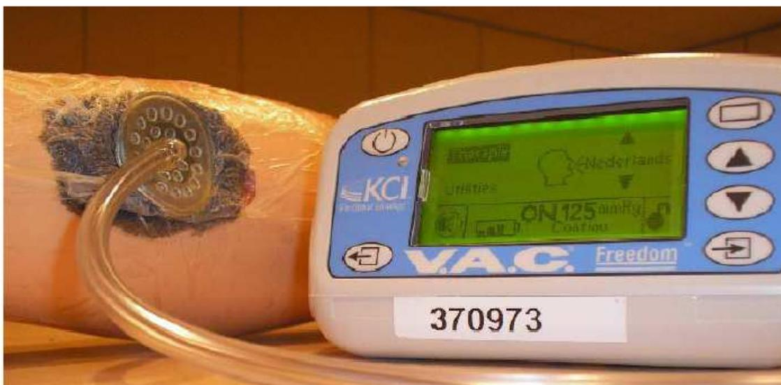
**Figura 3:** Exemplo de sistema de Curativo por Pressão Negativa - V.A.C System® (disponível em <http://www.kci1.com/KCI1/vactherapy>)
